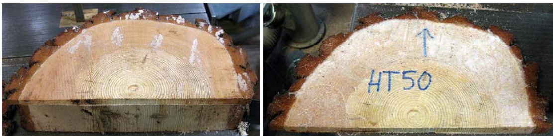
Figur 3: Exempel på ytterligare sågning av trissorna. Bilden till vänster visar en 1,5 cm tjock trissa innehållande mörgen från den norra halvan av trissa HT50.
