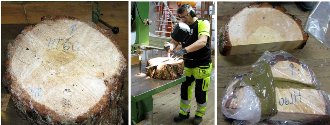
Figur 2: Exempel på grovsågningen av trissor på RISE. Den blåa pilen på bilden till vänster markerar var norr var när träden stod. Beteckningen HT60 betyder Hög bonitet, Tall, träd nr 6, trissa 0 (rotändan).
